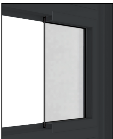
PARECLOSAGE PAR CADRE CLIPSÉ ET JOINT EPDM
